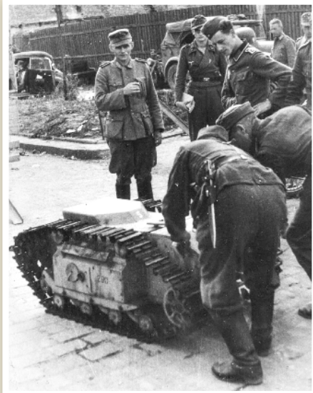
Den fjärrstyrda bandvagnen Goliath bar på sprängladdningar som på avstånd detonerades i fiendens befästningar.
